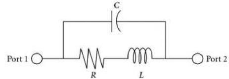
Figure 4. The real inductor schema.
